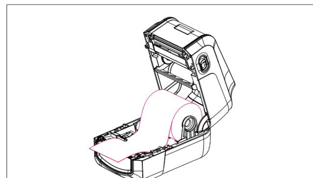
3. 将标签纸向前穿过间隙传感器和切刀进纸口(切刀选配)，完成安装。
