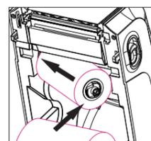
2. 将左侧卡入六角形转轮后，再将右侧卡入，并确认有无松动。
