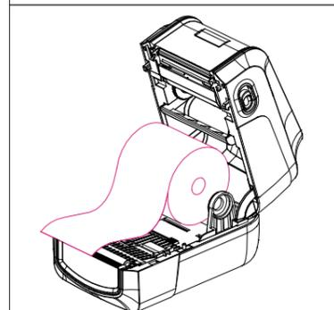
2. 用手打开卷纸固定夹，放入标签纸，放开手调整位置，让卷纸套紧卷纸夹。
