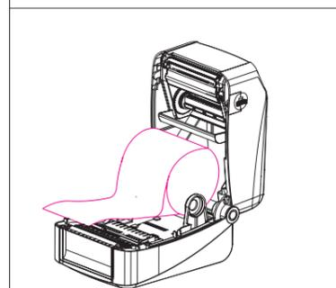
2. 用手打开卷标纸固定夹，放入标签纸，放开手调整位置，让卷标纸套紧卷标纸夹。
