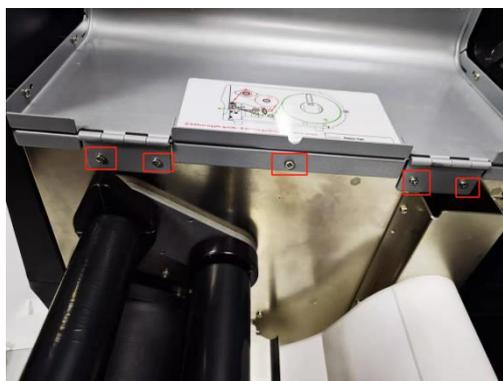
5. 取下打印机侧挡板与机罩。
