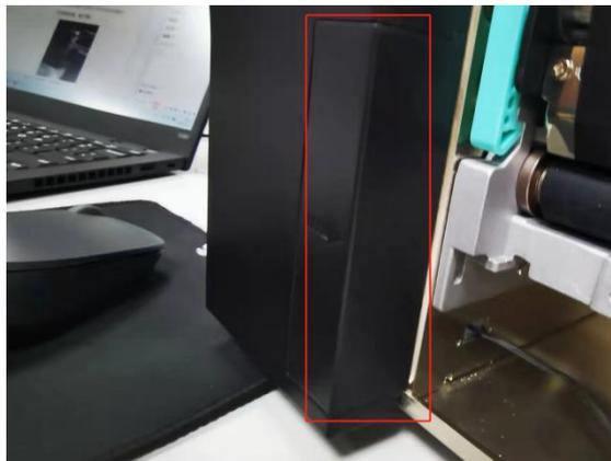
16. 装上打印机前挡板并装上两颗螺丝。
