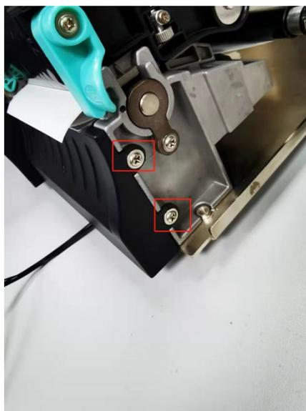
**17.** 安装打印机侧面挡板，从上往下安装挡板注意卡入滑槽内。
