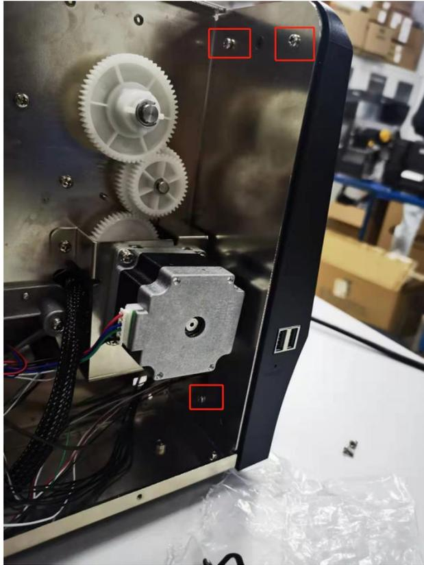
7. 打开塑料壳，将红色转接板的螺丝拆下。
