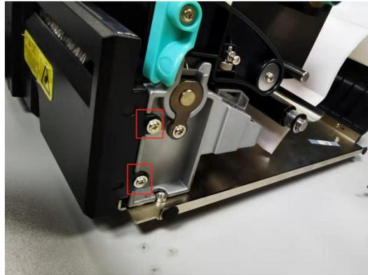
2. 拆除切刀螺丝后，拔掉切刀线端。
