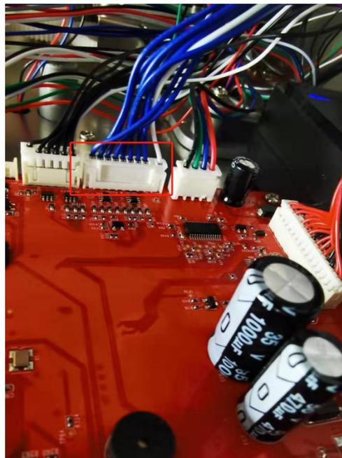
9. 将红色转接板的黑色线端的另一端拔掉。
