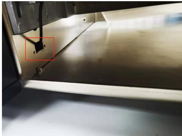
**13.** 将标签感应器线端插入线端口。
