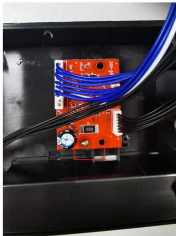
8. 拔掉打印机主板上蓝色线端端口。
